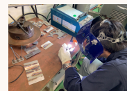
TIG溶接法による高品質・高精度な溶接
